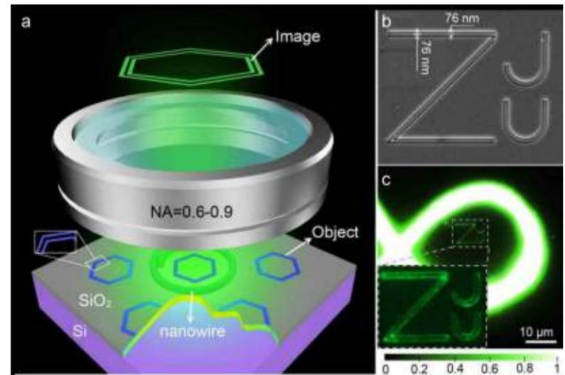
刘旭和杨青团队瞄准了国际上大视场、远场、无标记超分辨显微成像这一关键科学难题，他们开创性地将发光纳米材料作为局域光源，巧妙地利用其小尺寸、大表体比和强倏逝场等特点，并与二维波导相复合，在国际上首次实现了大视场的远场无标记超分辨显微成像，打破了目前超分辨显微领域的瓶颈，获得的视场比以往报道的无标记型远场超分辨显微方法扩展了2个数量级，且方便快捷、普适性强，在集成芯片、蓝光DVD、3T3 11癌细胞等不同领域的亚波长样品上均得到了验证。该技术成本低廉、与广泛使用的显微镜系统具有优秀的兼容性，可设计成紧凑型照明模块使普通显微镜具备超分辨能力。这些特点使其在生物医学、集成工艺、材料科学等重要领域具有广阔的应用前景，同时也为推进微纳发光器件的实际应用迈出了重要的一步。
